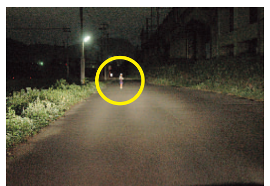
【上向きライトでの照射範囲】 歩行者がはっきり確認できます
