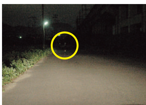
【下向きライトでの照射範囲】 歩行者がよく確認できません
